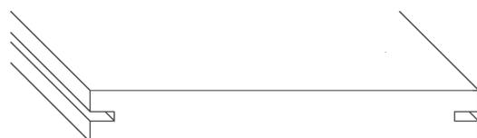
Listone in composite bamboo, fresato per il fissaggio con clips.
