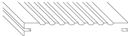
Listone in massello strand termotrattato, fresato per il fissaggio con clips su magatelli.
