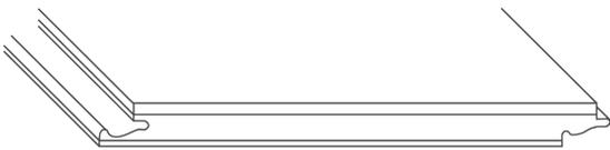
Listone costituito da tre strati: faccia superiore in bambù, spessore 2,5 mm.
