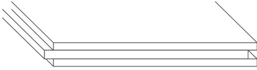
Listone costituito da tre strati: faccia superiore in bambù, spessore 4 mm.
